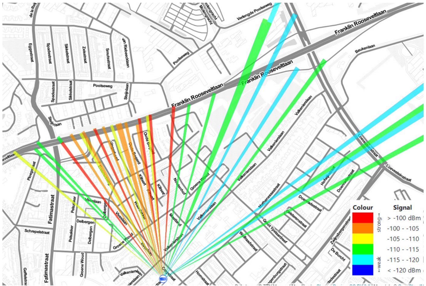
Figuur 2 Gateway met sterkte van ontvangen sensor signaal
